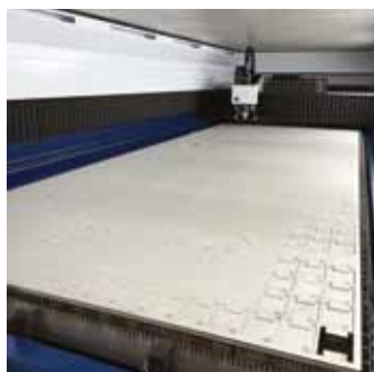
Mit dem TruLaser 5060 fiber können Bleche im Überformat bis zu 6000 x 2000 mm Dicke bearbeitet werden. Foto: Edelstahl Mechanik GmbH
