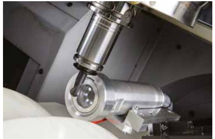
Ein widerstandsfähiges Gehäuse mit Sperrluftfunktion schützt das empfindliche Mikroskop.
