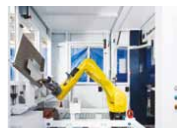
Bei der Flex Cell be- und entlädt ein Industrieroboter die TruBend 7050 selbstständig. Foto: TRUMPF
