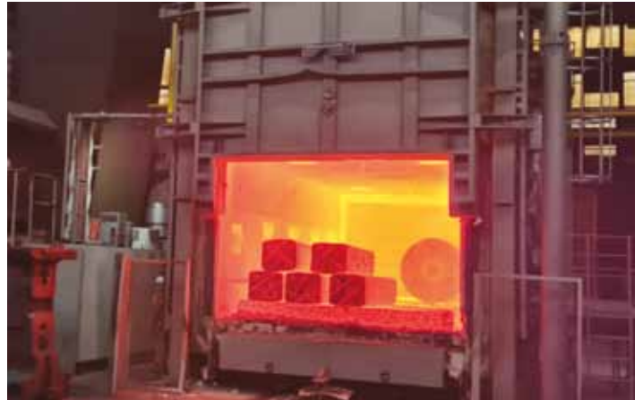
Ein Wiedererwärmungs-ofen im Betrieb.
