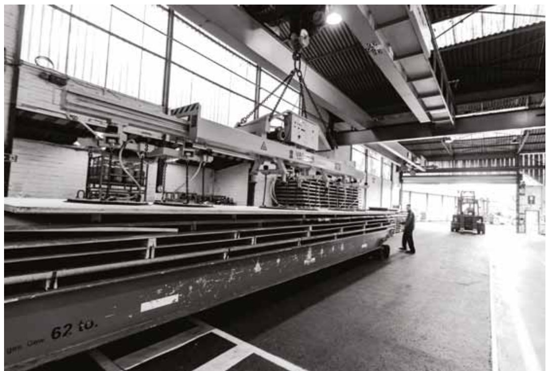
12 Meter lange Bleche werden „just in time“ auf Kundenwunsch abgelängt. Fotos: HW-INOX
