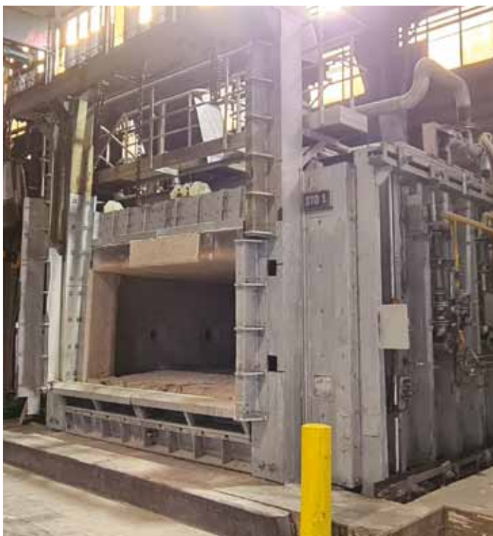
2MW Wiedererwärmungs-ofen am Standort Krefeld.
