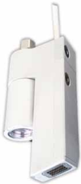
Abb. 5: Der kompakte Prüfkopf für die berührungslose einseitige Ultraschall-Prüfung von Werkstücken und Schweißverbindungen. In ihm werden Anregungslaser und Optisches Mikrofon vereint. Kein Gel oder Wasser ist nötig.
