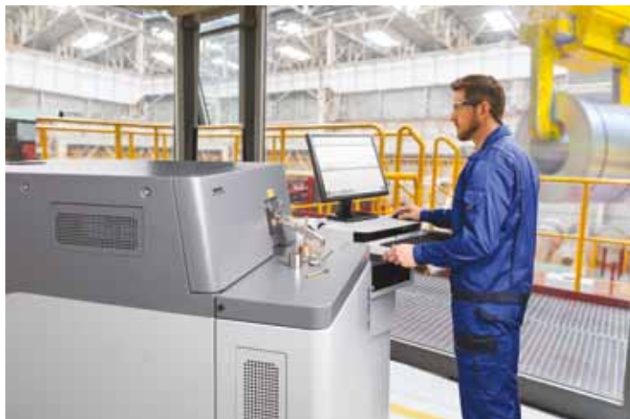
Stationäre Metallanalysegeräte eignen sich für alle Metallarten in der Prozessindustrie. Foto: Spectro
