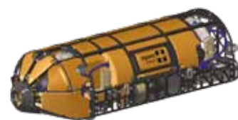
Square Robot Inc. bietet Inspektionsdienste für oberirdische Lagertanks mit Hilfe autonomer Tauchroboter. Grafik: Square Robot
